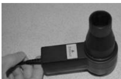
Bon montage : l'ergot est inséré dans la poignée.
